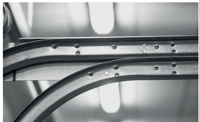
Alle von uns gelieferten Beschläge werden bei der Herstellung durch Ritz-▲ zen oder Toxen verbunden. Diese moderne Produktionsmethode garan- tiert eine hohe Festigkeit der Verbindung und eine lange Lebensdauer.
