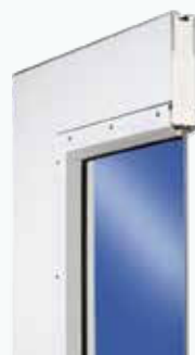
PMMA-Doppelscheibe 18 mm, VSG 6 mm bzw. Doppel-Verbundsicherheitsisolierglas 21 mm dick (VSG/VSG), mit Stahl-Glashalteleisten. Schlagregendichtigkeit Klasse 3, empfohlen bei Außentoren
