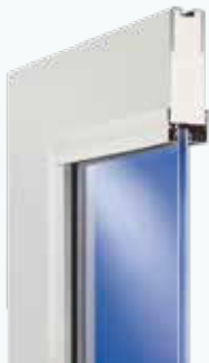
PMMA-Doppelscheibe 18 mm, VSG 6 mm bzw. Doppel-Verbundsicherheitsisolierglas 21 mm dick (VSG/VSG), mit Aluminium-Glashalteleisten.
